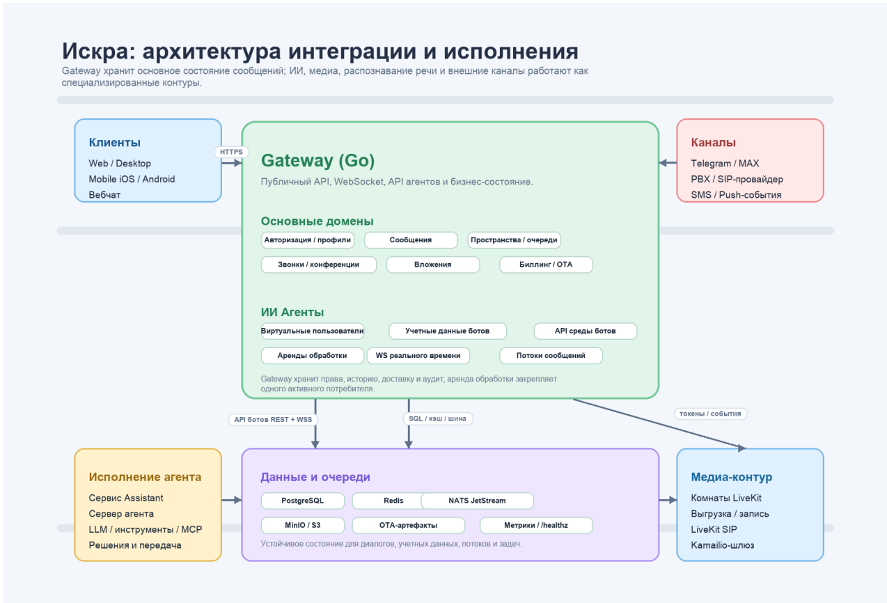
Рисунок 1. Архитектура исполнения Искры: клиенты обращаются к Gateway, Gateway управляет основными доменами и передает специализированные задачи сервисам ИИ, медиа, распознавания речи, хранилища и внешних интеграций.
